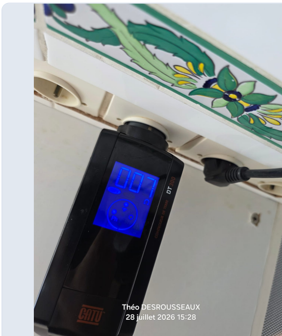
📷 CATU DT300 sur une prise de cuisine avec lecture visible de 7 \Omega .
