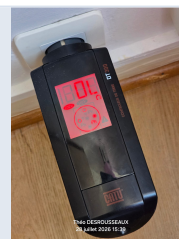
CATU DT300 sur une prise avec affichage OL et alerte rouge.
