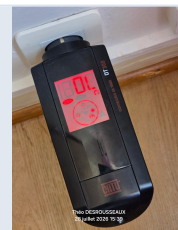
CATU DT300 sur une prise avec affichage OL et alerte rouge.
