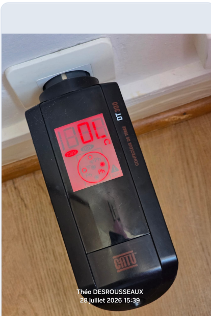
📷 CATU DT300 sur une prise avec affichage OL et alerte rouge.
